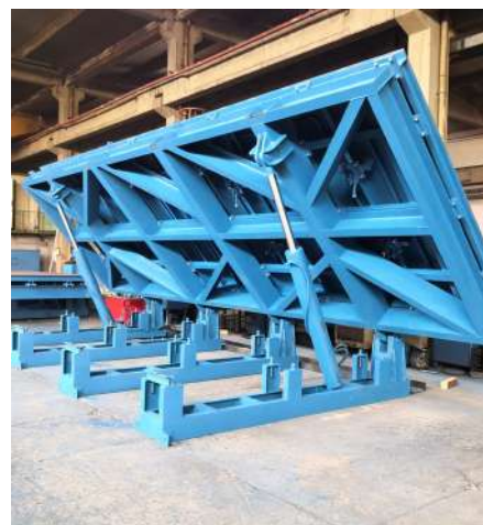
Tachkent / OUZBEKISTAN Moule mural sur table basculante (Tilt-Up)
